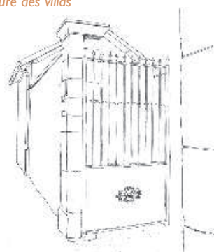
Mur et pile maçonnés avec portail en ferronnerie disposé en feuillure
