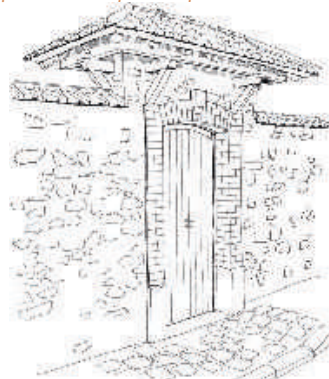
Portillon entre jambages et linteau cintré en brique, surmonté d'un auvent charpenté à quatre pans recouverts de tuile, caractéristique d'une époque et d'un style de villa
