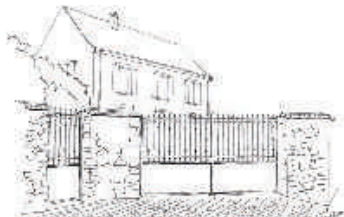
Portail et portillon, droits, de la même hauteur que le mur de clôture en moellon à pierre vue protégé en tête par un rang de tuiles
