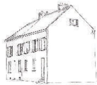
Faîtages, égoûts de toiture et linteaux alignés sur deux maisons mitoyennes. L'ouverture dans le pignon n'est pas dans l'axe du faitage
