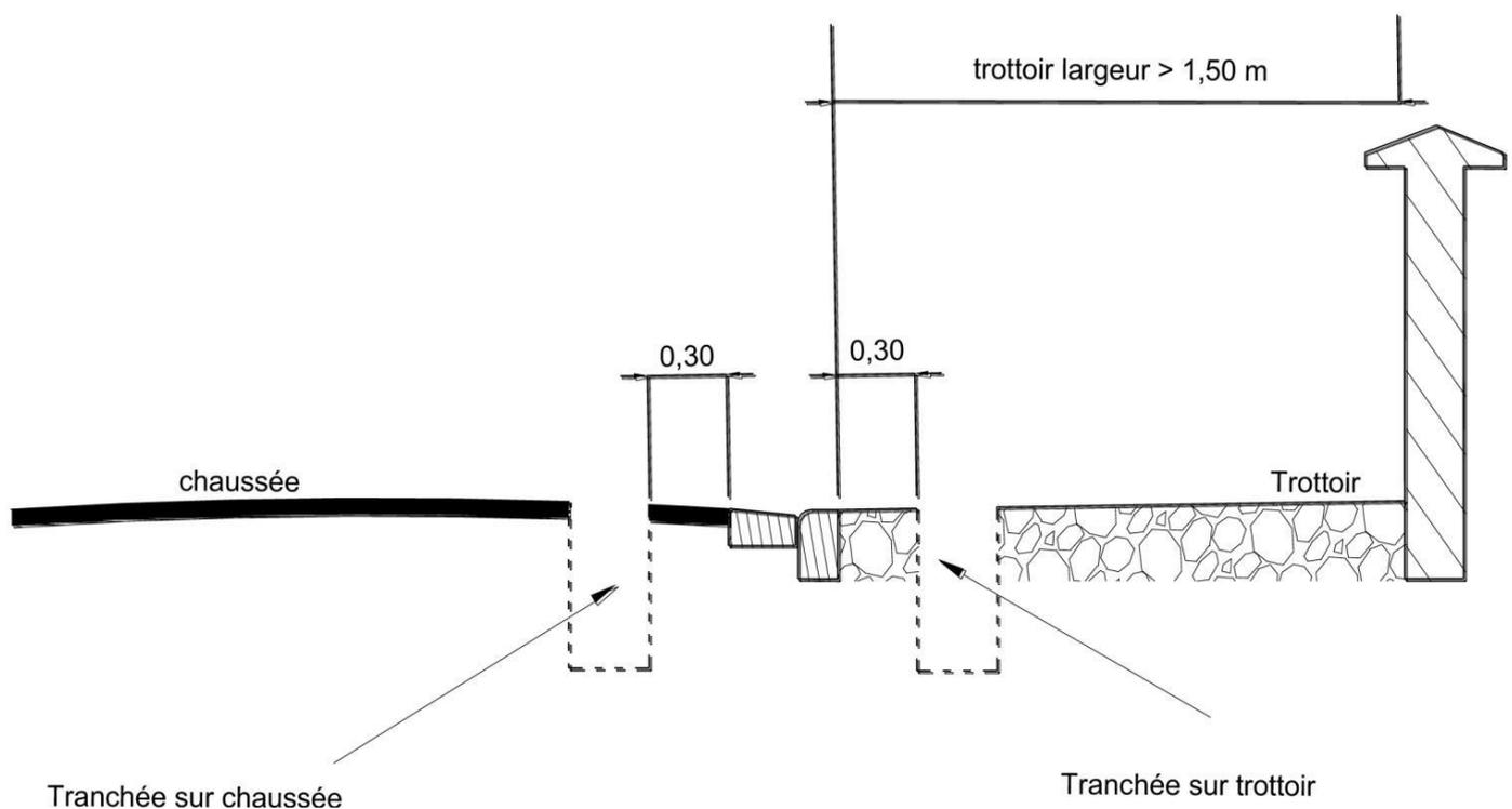
Aucune déformation transversale à l'axe de la tranchée en surépaisseur ou en profondeur à 1 cm sous une règle de 1,00 m ne sera acceptée (ne sont pas concernées les réfections provisoires en période hivernale ou d'intempéries).
