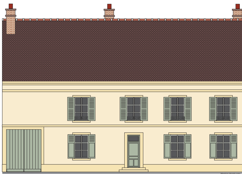
Un enduit lissé renforce parfois les chaînages d'angles, bandeaux de façades et encadrements de fenêtres
