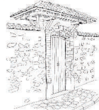
Portillon entre jambages et linteau cintré en brique, surmonté d'un auvent charpenté à quatre pans recouverts de tuile, caractéristique d'une époque et d'un style de villa
