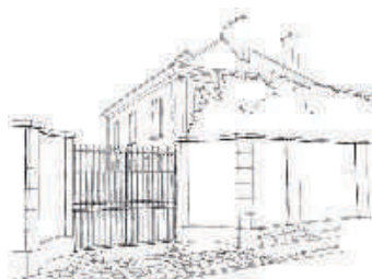
Portail en ferronnerie de même hauteur que le mur d'enceinte enduit
