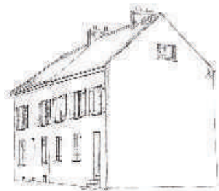
Façades, égoûts de toiture et linteaux alignés sur deux maisons mitoyennes. L'ouverture dans le pignon n'est pas dans l'axe du faîtage
