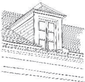
Lucarne à engranger engagée dans le toit, pour accès à l'étage dit "à encuvement"
