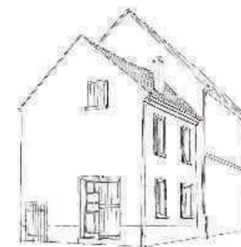
Les ouvertures en pignon ne se font jamais dans l'axe du faîtage et sont plus hautes que larges
